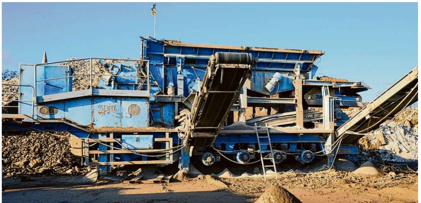
Der angelieferte Bauschutt wird mit der radmobilen Brecheranlage zerkleinert. Anschließend wird das Material weiterverarbeitet und kann dann erneut verwendet werden. Für jedes Einsatzgebiet stehen passende Produkte zur Verfügung.
